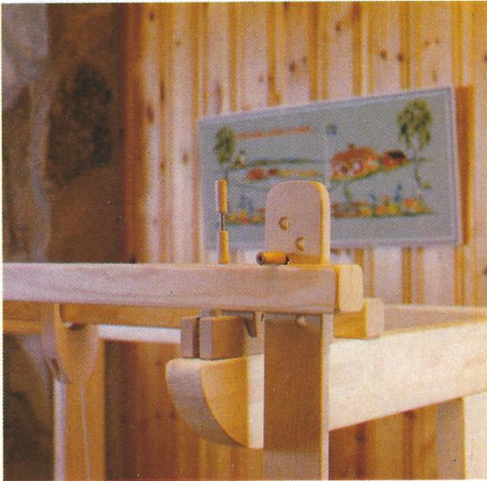
Hier ein kleiner Beweis dafür, dass wir alles daran setzen, unsere Webstühle so funktionell und solide wie möglich zu machen. Der Keil, der das Rahmenbrett hält, wurde mit einem grosszügigen Einschnitt versehen, sodass er nicht mit einer Schnur oder einem Klebstreifen gesichert werden muss. Die Wiegen können feinjustiert werden. Die Schlagleisten wurden aus Buchenholz hergestellt, um einen gleichmässigeren Anschlag zu erhalten.
