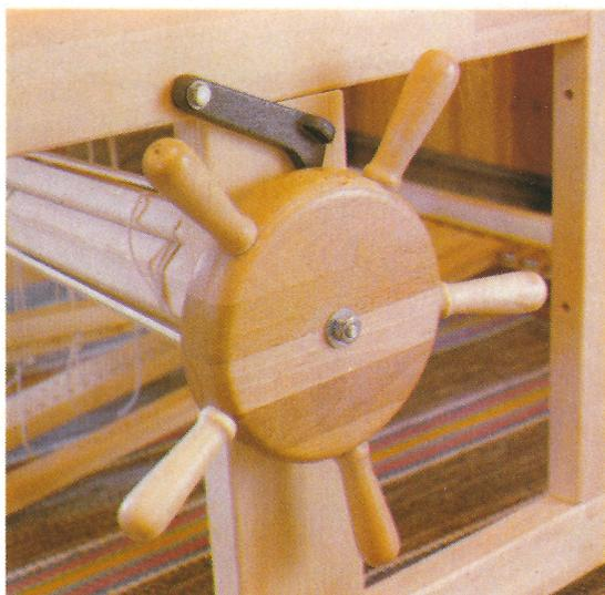
Die Spannanordnung wurde aus Buchenholz hergestellt und ist aus mindestens fünf Lamellen verleimt. Die Handgriffe aus Birkenholz haben reelle Abmessungen und sind 6 cm in die Spannanordnung eingebohrt.
